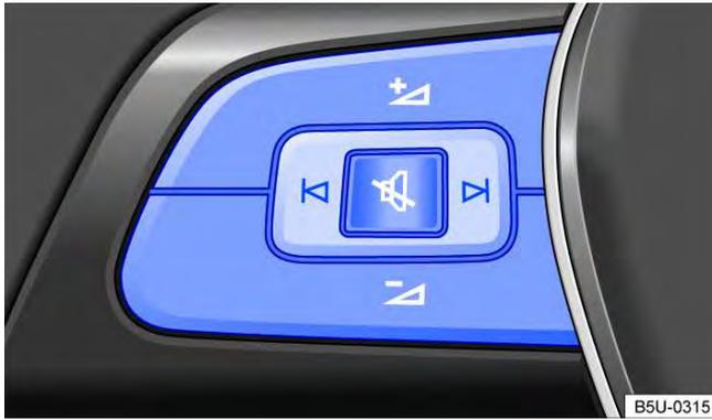
**Fig. 44** Lado esquerdo do volante multifunções: teclas de comando.
