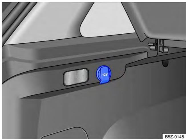
Fig. 126 No compartimento de bagagem: tomada 12 V.
