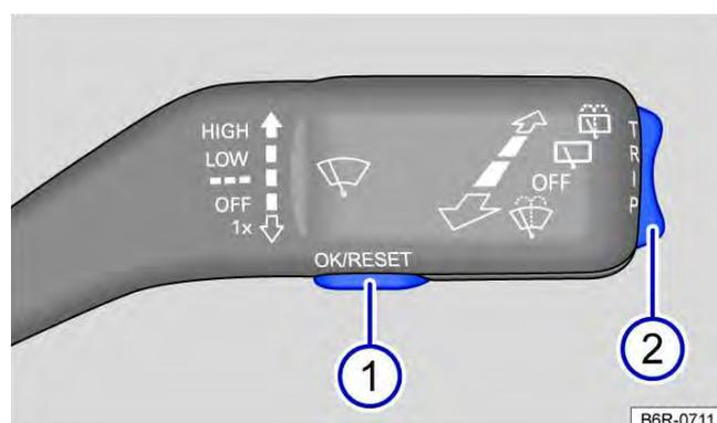
**Fig. 42** Veículos sem volante multifunções: tecla ① na alavanca dos limpadores dos vidros para confirmação dos itens de menu e chave ② para alternar entre os menus.
