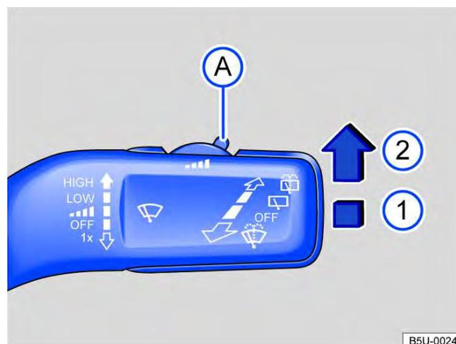
**Fig. 78** Ao lado do volante: alavanca dos limpadores dos vidros: regular a sensibilidade do sensor de chuva (A).
