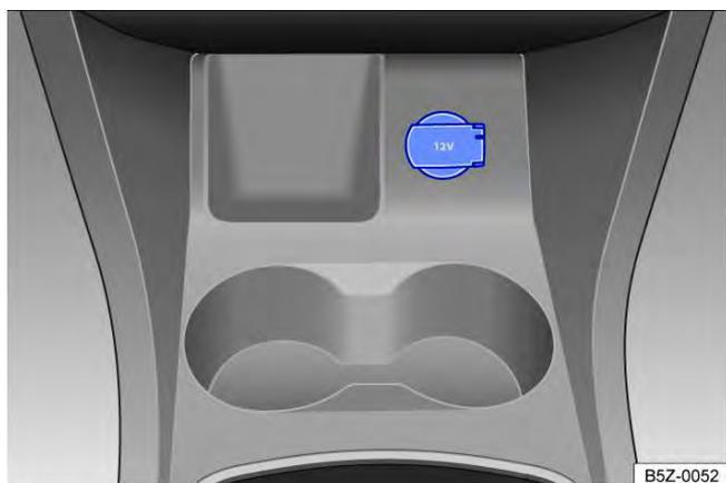
Fig. 125 No console central dianteiro: tomada 12 V.
