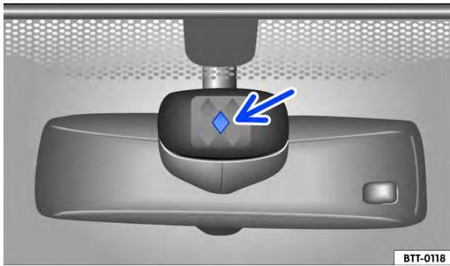
**Fig. 79** No para-brisa: superfície sensível do sensor de chuva.
