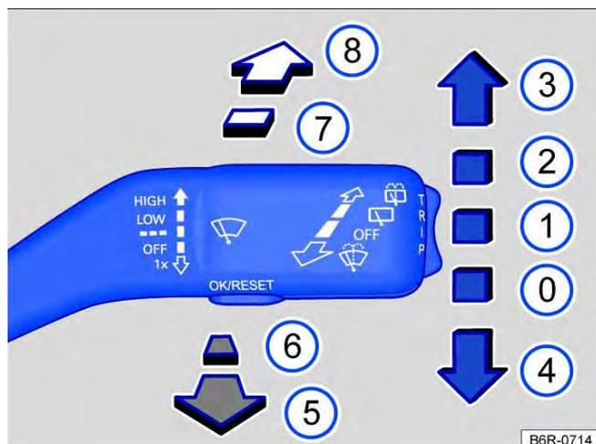
**Fig. 77** Comandar os limpadores / lavadores do para-brisa e o limpador / lavador do vidro traseiro.
