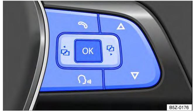
**Fig. 45** Lado direito do volante multifunções: teclas de comando.
