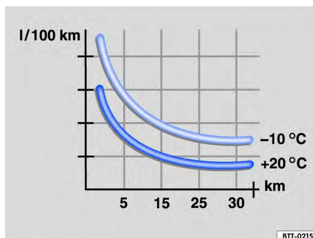
**Fig. 94** Consumo de combustível em l/100 km em 2 temperaturas ambiente diferentes.
