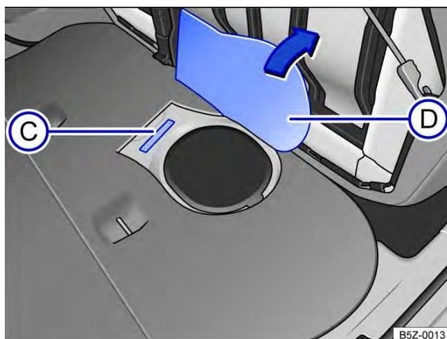
**Fig. 189** Debaixo do banco traseiro sob o revestimento do assoalho (D): número de identificação do veículo (C).
