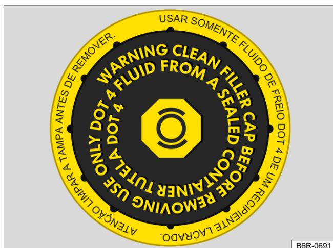
Fig. 167 No compartimento do motor: tampa do reservatório de fluido de freio (variante 1).
