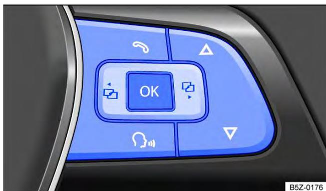
**Fig. 43** Lado direito do volante multifunções: teclas de comando dos menus do instrumento combinado.
