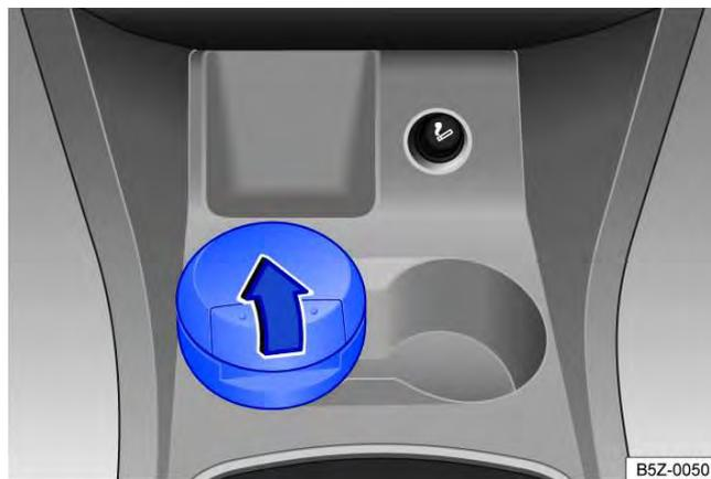
**Fig. 123** No console central dianteiro: abrir o cinzeiro.
