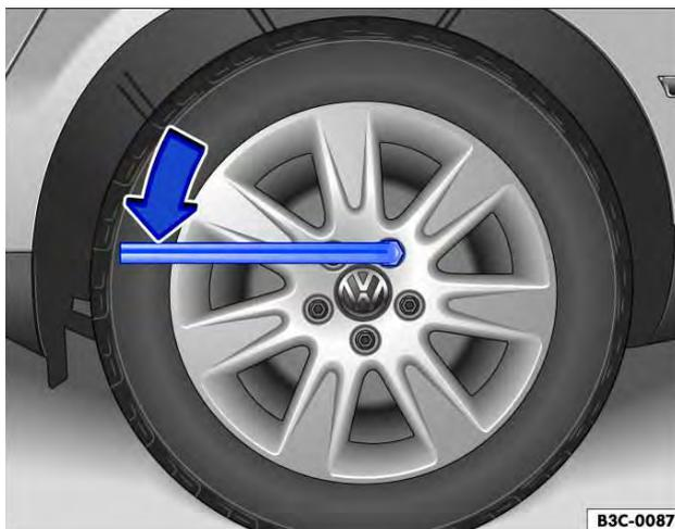
Fig. 179 Troca de roda: soltar os parafusos da roda.
