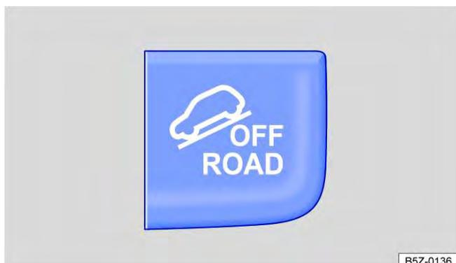
Fig. 105 No console central: botão para ligar e desligar o modo off-road manualmente.
