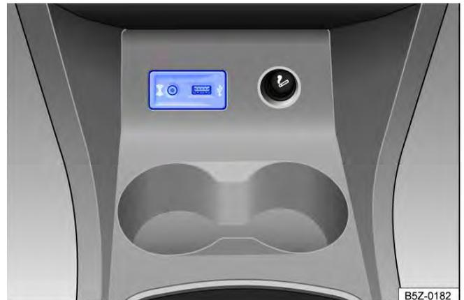
**Fig. 117** No console central dianteiro: interface USB e entrada AUX-IN
