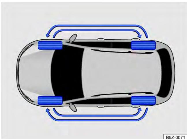
**Fig. 172** Esquema para a troca das rodas.
