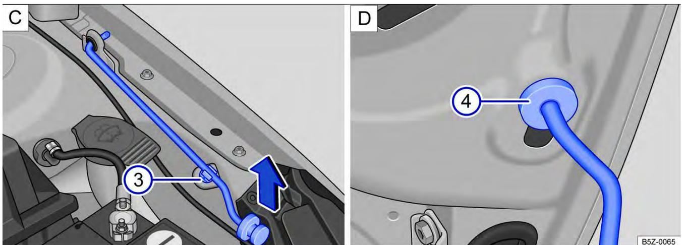
**Fig. 161** C: haste de sustentação da tampa do compartimento do motor (3). D: tampa do motor protegida com a haste de sustentação da tampa (4).
