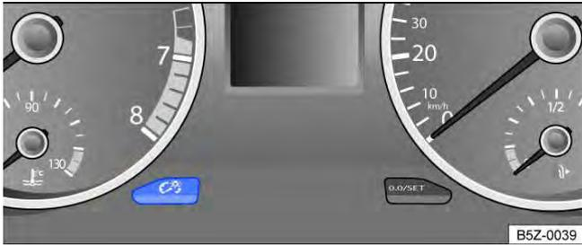
**Fig. 76** No instrumento combinado: botão de regulação da iluminação dos instrumentos e dos interruptores.
