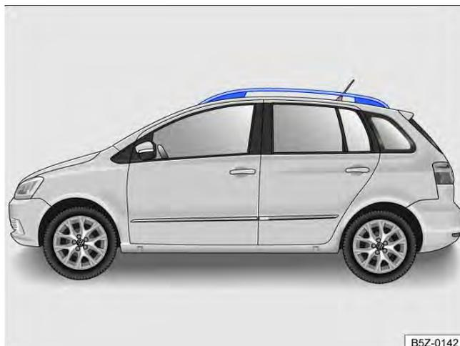
Fig. 128 Suportes longitudinais do bagageiro do teto (ambos os lados).
